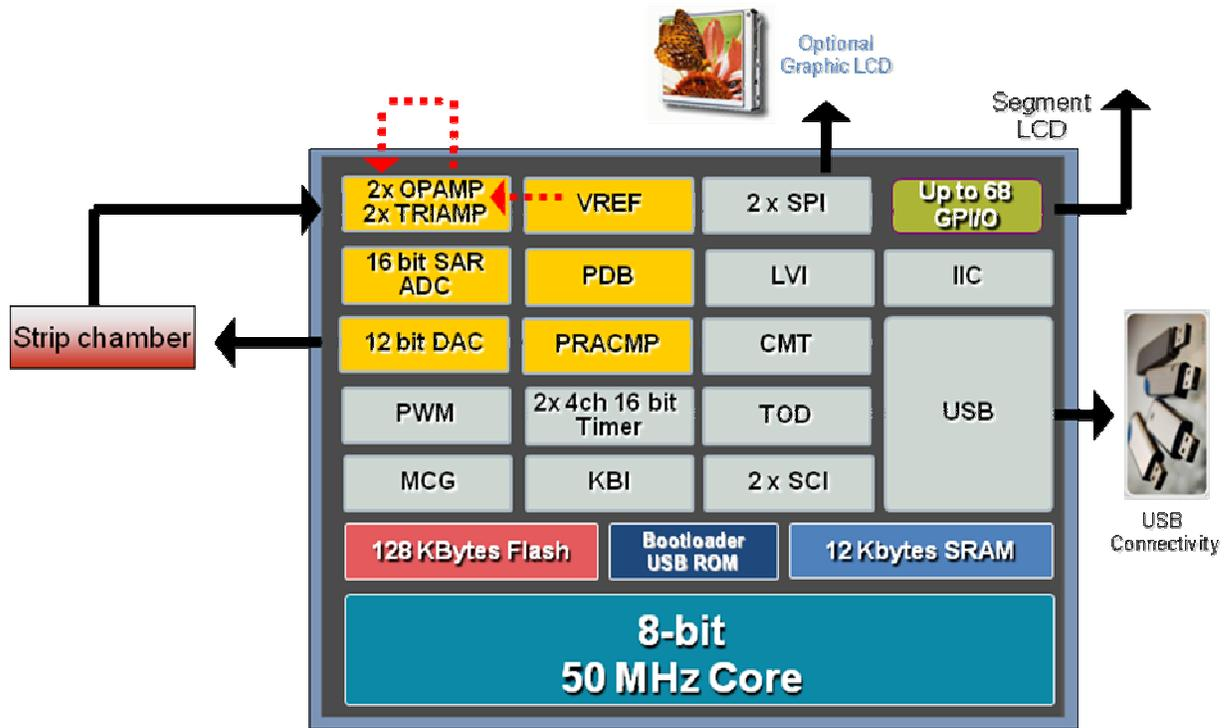
**Fig 4. Glucometer system**
