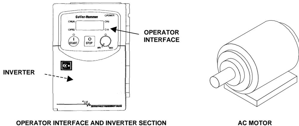
FIGURE 2. TYPICAL ADJUSTABLE FREQUENCY DRIVE COMPONENTS
